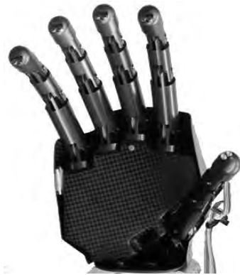
FIGURA 16. Mà amb dits poliarticulats per a la implementació de pròtesis destres.
