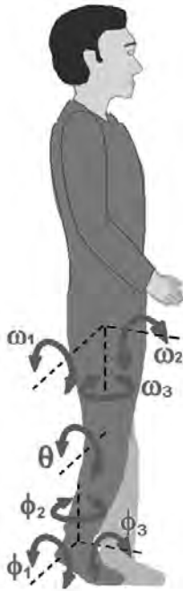
FIGURA 15. Graus de llibertat de la cama.
